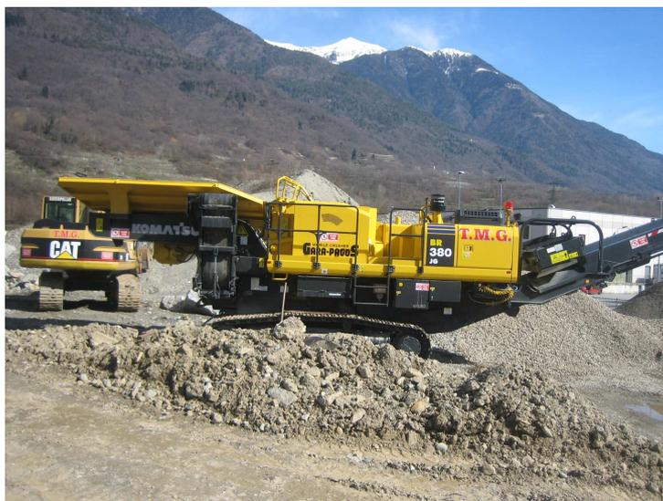
Il ciclo produttivo della macchina inizia dall'alimentazione a piastre, nella cui tramoggia viene caricato il materiale da frantumare per mezzo di un escavatore. L'alimentazione a piastre scarica gradualmente il materiale sul vaglio vibrante che esegue una prima selezione del materiale fine che viene convogliato sul nastro trasportatore, mentre il materiale a pezzatura maggiore avanza verso la bocca del frantoio.
