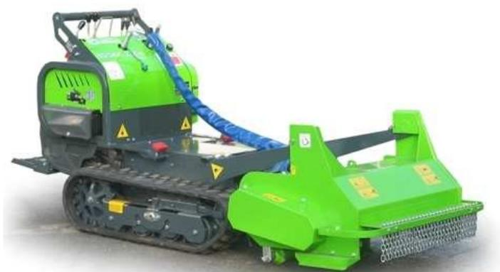
Trinciasarmenti montata su minitransporter cingolato, ditta Merlo S.p.A.
