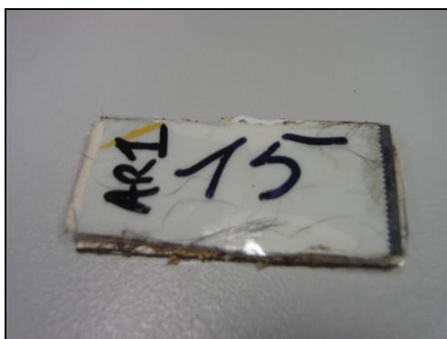
Fig. 3.2 - Placche con nastro biadesivo dopo il controllo
