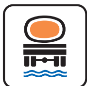
Figura II 158 Art.125 AUTOCISTERNA CON PRODOTTI CONTAMINANTI
